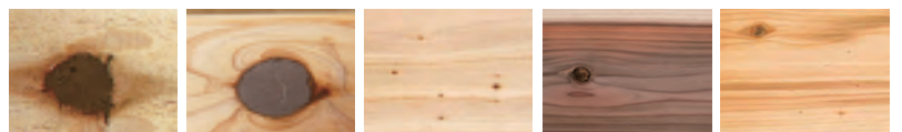
パテ BSK (表面粗挽き) パテ LOK (表面プレーナー) 葉節 (気根) 黒心 材の濃淡
